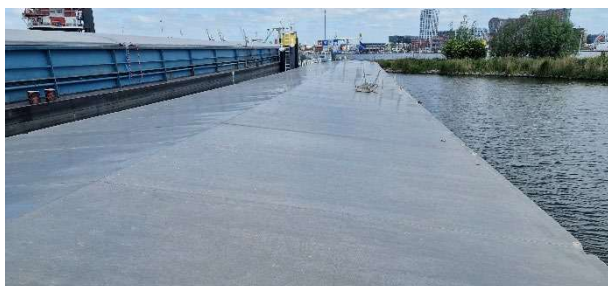
Luiken met hydraulisch hef-/stapelsysteem
