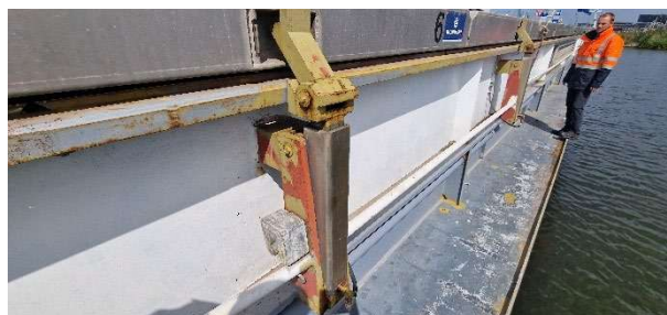
Luiken met hydraulisch hef-/stapelsysteem
